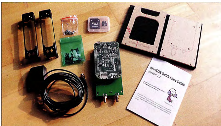
Bild 1: KiwiSDR mit BeagleBone-Platine, GPS-Antenne, Gehäusebausatz, SD-Karte nebst Software und Adapter Foto und Screenshots: DJ6JZ
