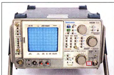
Bild 13: Der Spektrumanalysator TEK 492P wurde sowohl als Messgerät als auch als Messobjekt genutzt.
