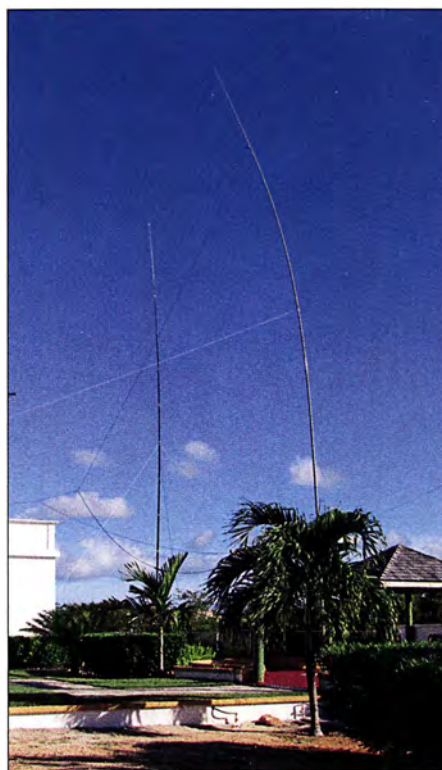
30-m-Loop – für die obere Befestigung wurde der rechte Glasfaserstab genutzt; der linke diente für 80 m bzw. 160 m als Vertical.
