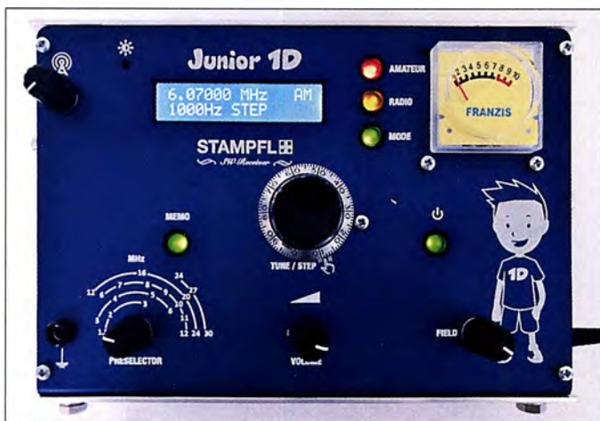
Bild 1: Frontansicht des modifizierten Junior 1D im selbst gebauten, pultförmigen Gehäuse
