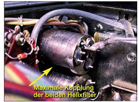
Bild 5: ... und ermöglicht somit eine veränderbare Kopplung zum benachbarten Filter.
