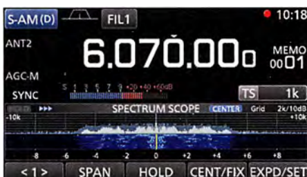
So gut kann AM klingen: Radio DARC auf 6070 kHz mit aktiviertem AM-Synch des IC-R8600.
