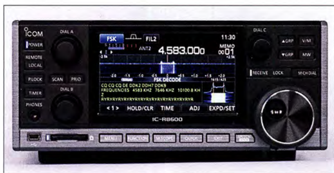
Im Zentrum der Frontplatte des Icom IC-R8600 informiert ein Farbbildschirm über Empfangsparameter; im FSK-Modus wird darauf die decodierte RTTY-Sendung gezeigt.
