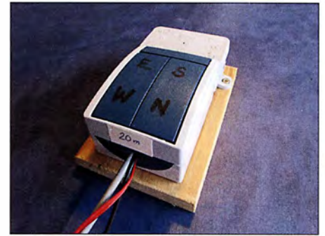
Bild 35: Doppel-Wippenschalter zur Auswahl der Antennenrichtung
