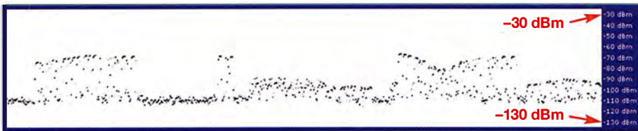
Bild 7: Zwei Stationen im CW-QSO; das S-Meter-Diagramm zeigt Störabstände von etwa 20 dB bzw. 60 dB.
