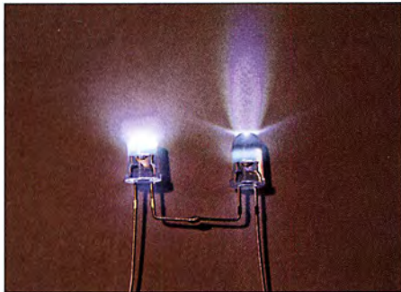
Bild 12: Die bearbeitete LED (links) hat die gewünschte, deutlich breitere Lichtabstrahlung im Vergleich zur Original-LED.
