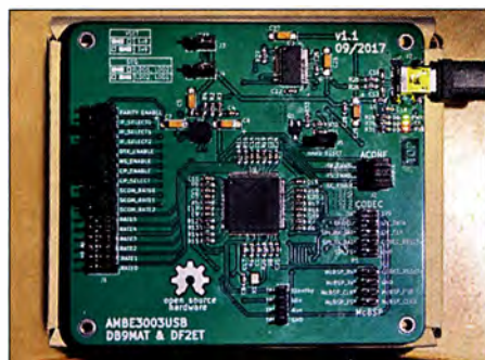
Bild 1: Prototyp des Transcoder-Experimentierboards von DF2ET für XLX-Reflektoren
