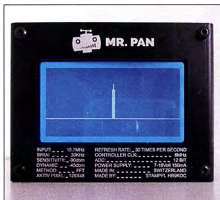
Bild 6: Das Panorama-Sichtgerät Mr. Pan stellt das Signalspektrum eines 30 kHz breiten Ausschnitts des Empfangsbands dar.
