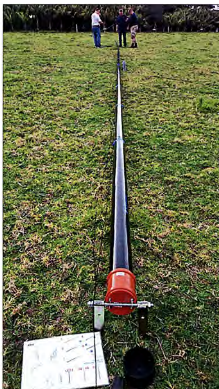
Bild 24: Kippgelenk für den 26-m-GFK-Mast
